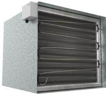
Капиллярная трубка прокладывается с теплой стороны калорифера поперечно или параллельно теплообменным трубам (мы рекомендуем параллельную прокладку) с покрытием всей площади (для защиты калориферов большой площади может понадобиться несколько защитных термостатов). Для исключения повреждения капиллярной трубки требуется выдерживать минимальный радиус изгиба 20 мм и использовать скобы.
