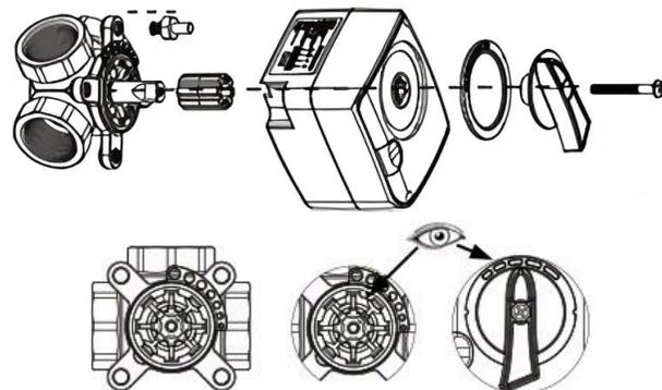
1. Разберите ручку клапана, привинтите противоразрешитель к крышке клапана и установите переходник клапана на вал ротора
