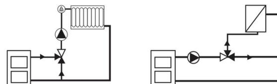
Смешение потоков (реверсивная установка)      Разделение потоков (реверсивная установка)
