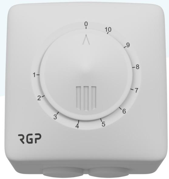
Электронные регуляторы скорости STY предназначены для управления скоростью вращения электродвигателей вентиляторов. Позволяют ручное регулирование скорости вращения и могут использоваться для управления несколькими электродвигателями, если общий ток не превышает предельное значение симистора.
