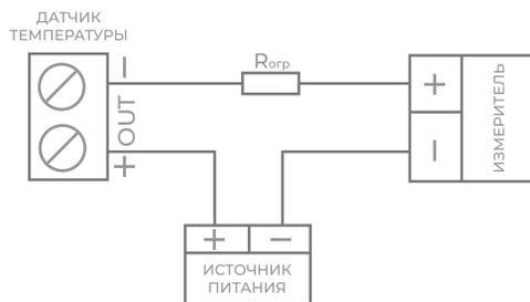
Принцип работы преобразователя основан на линейном преобразовании сопротивления измерительного элемента Pt1000 в унифицированный нормированный сигнал 4-20 мА.
