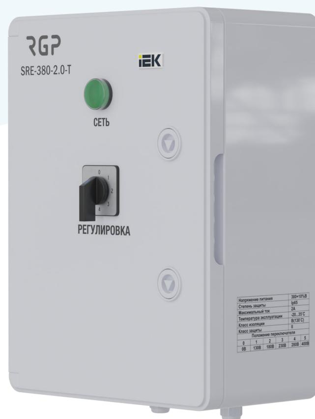
Регуляторы скорости SRE-380 предназначены для ступенчатого регулирования скорости вращения трехфазных электродвигателей вентиляторов и регулирования расхода воздуха в системах вентиляции. Корпус регулятора изготовлен из прочного пластика и обеспечивает защиту не ниже IP65.
