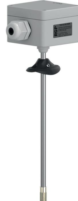
Для измерения параметров воздуха в преобразователях THS используются цифровые измерительные элементы с диапазоном измерения -40...+120 °C и 0...100% RH, которые преобразуются и передаются на выходные клеммы в виде 0-10В.
