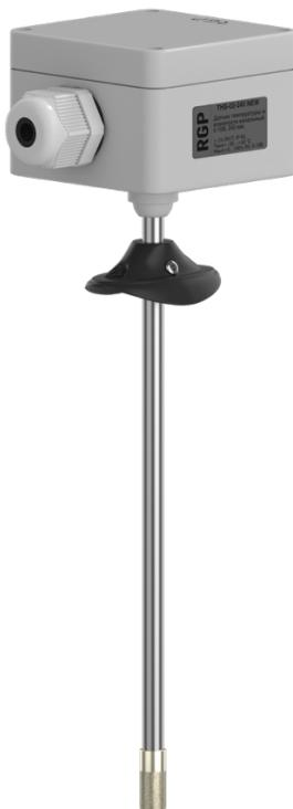
Канальный преобразователь влажности (канальный датчик влажности) HS-02 с длиной измерительной трубы 100, 240 и 340 мм. измеряет относительную влажность воздуха посредством измерительного элемента компании Silicon Labs.
