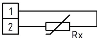
Используйте двухжильный кабель диаметром до 8 мм. и сечением жилы до 1,5 мм<sup>2</sup>. Рекомендуется использовать экранированный кабель и выдерживать минимальную дистанцию в 15 см между кабелем датчика и кабелем (проводом) с напряжением 220 В и выше.
